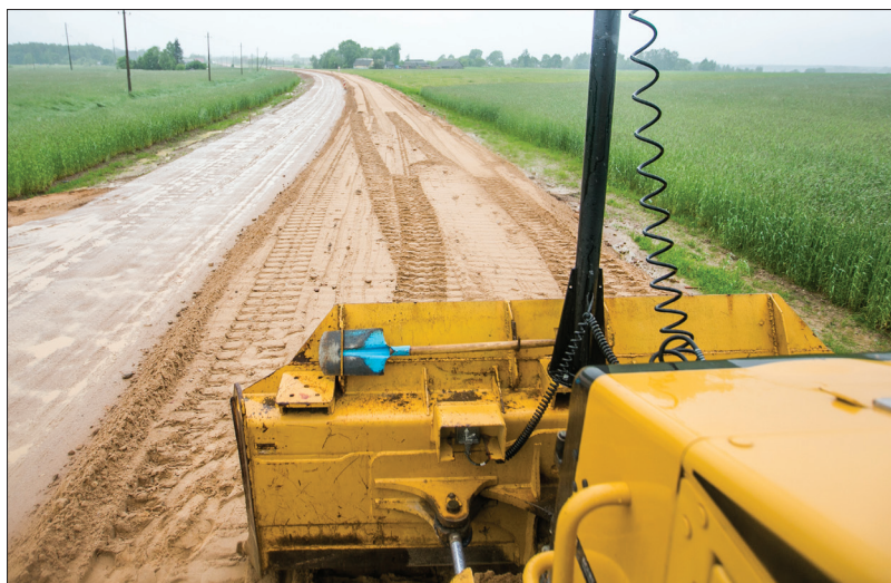
Į mechanizmą įdiegta automatinio valdymo sistema, kuri leidžia pozicionuoti mechanizmo vietą statybos aikštelėje.
