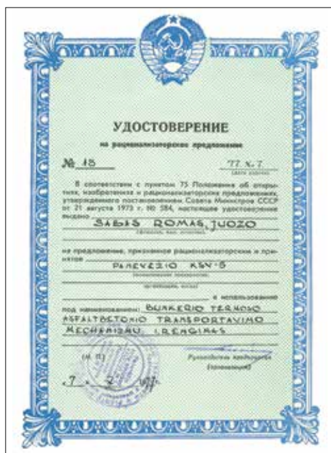
Bunkerio termosio asfaltbetoniui transportuoti mechanizmų įrengimas. 1977 m. spalio 7 d. Buvo siekta, kad gabenamas asfaltbetonis kaip galima ilgiau išlaikytų darbinę temperatūrą.
