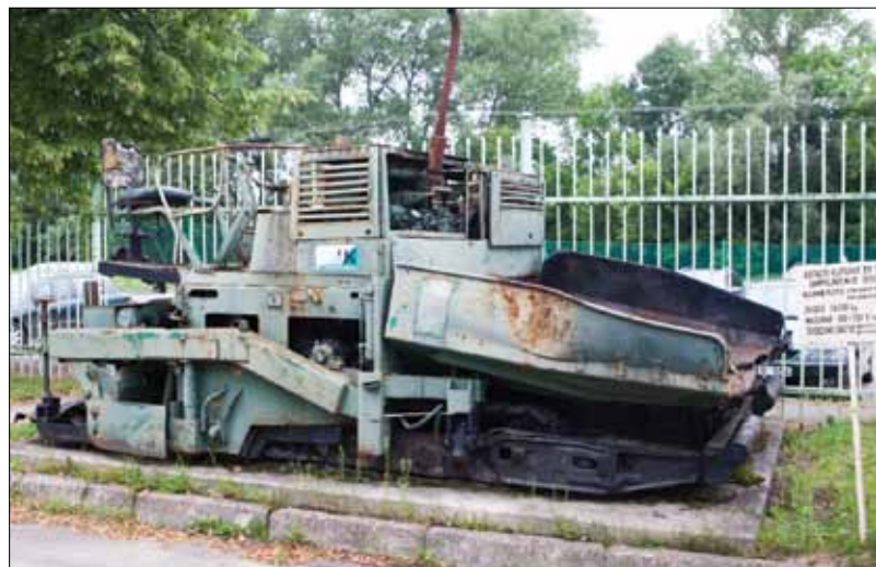
Asfalto klotuvas „DS 126“. 1976 metai. Klojimo plotis be paplatintojo – 3 metrai, su paplatintoju – 3,75 metro. Svoris – 13 tonų.
