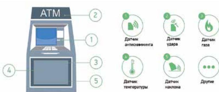
*Ил. 17. Датчики реагирования и уведомления системы видеомониторинга ATMeve.iQ.*
